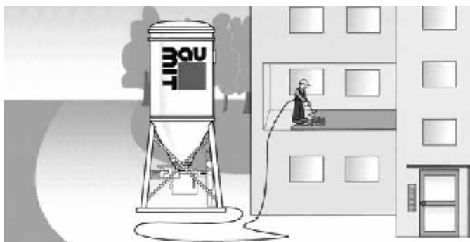
3.36 Schématické znázornenie logistiky strojného spracovania sadrových poterov Zostava: beztlakové silo + silová miešacia stanica SMP FE
