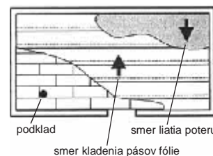
3.28 Smer liatia poterovej zmesi v závislosti od uloženia pásov fólie (pásy fólie preložené bez vodotesného spojenia)
