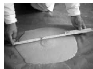
3.22 Meranie konzistencie poterovej zmesi – skúška rozlívom
